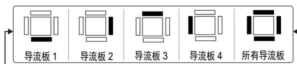
→ 有关各室内机的导流板编号, 请参阅 < 单个导流板 (Individual louver) (为各个排气口选择风向) >。(第 22 页)
